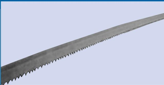
Curta no lado dos dentes é um termo usado para descrever a retilinidade da lâmina. Os dentes estão internos ao arco formado quando a lâmina é esticada em uma superfície plana.
