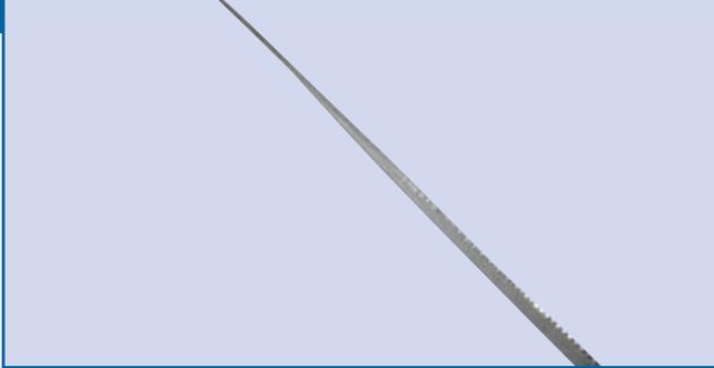
Quando uma lâmina quebrada é esticada em uma superfície plana, apresenta uma torção de uma ponta à outra, isto indica que o alinhamento da lâmina foi alterado durante o uso.
